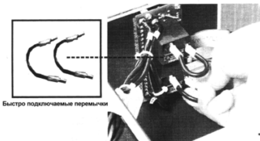
Рисунок 8. Вид сзади распределительного модуля с плавкими предохранителями с перемычками для шунтирования контактора для отключения из-за низкого напряжения
