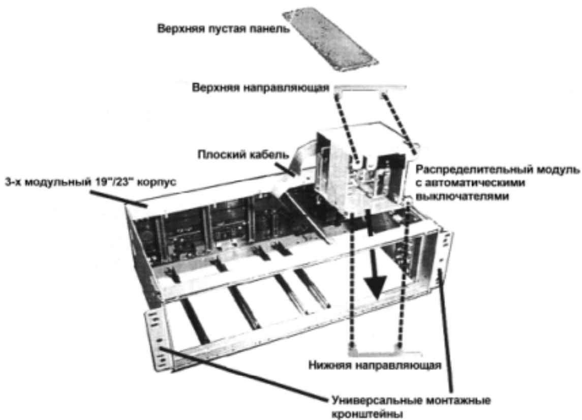
Рисунок 6. Установка распределительного модуля с автоматическими выключателями
